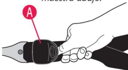
Incline el ajustador **A** y deslice la correa para aflojarlo.
